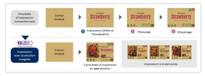
Grâce à sa technologie **jet d'encre 100% à froid, l'Integlide** contribue à **réduire l'impact environnemental** en minimisant la consommation d'énergie. Équipé de **têtes d'impression piézoélectriques** et utilisant une **encre à base d'huile résistante à l'eau**, le système assure une impression durable et de haute qualité, un atout majeur pour le secteur de l'emballage.
